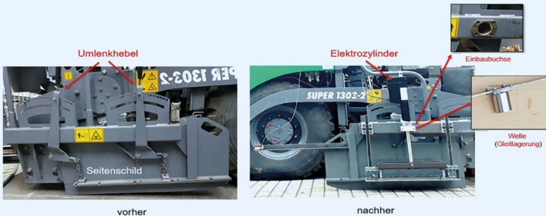
Abb. 6: Verstell-Mechanismus (mit Umlenkhebel) im ursprünglichen Zustand (links) und Umsetzung des Konzepts zur automatischen Verstellung des Seitenschildes (rechts)
