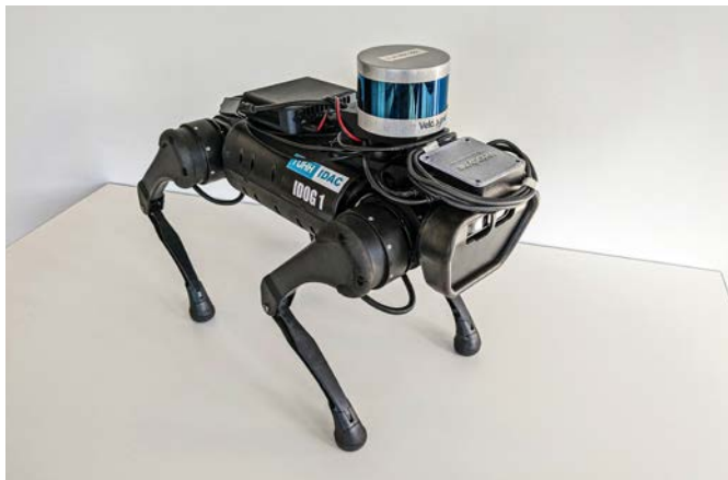
Der Roboterhund IDOG basiert auf dem Modell A1 eines chinesischen Herstellers Unitree und wurde um Sensorik und Software erweitert.
